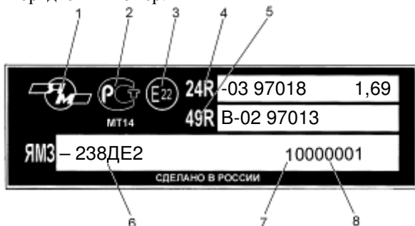
Рис. 49. Заводская табличка двигателя ЯМЗ-238ДЕ2.
