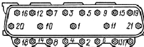
Рис. 54. Порядок затяжки гаек крепления головок цилиндров:
