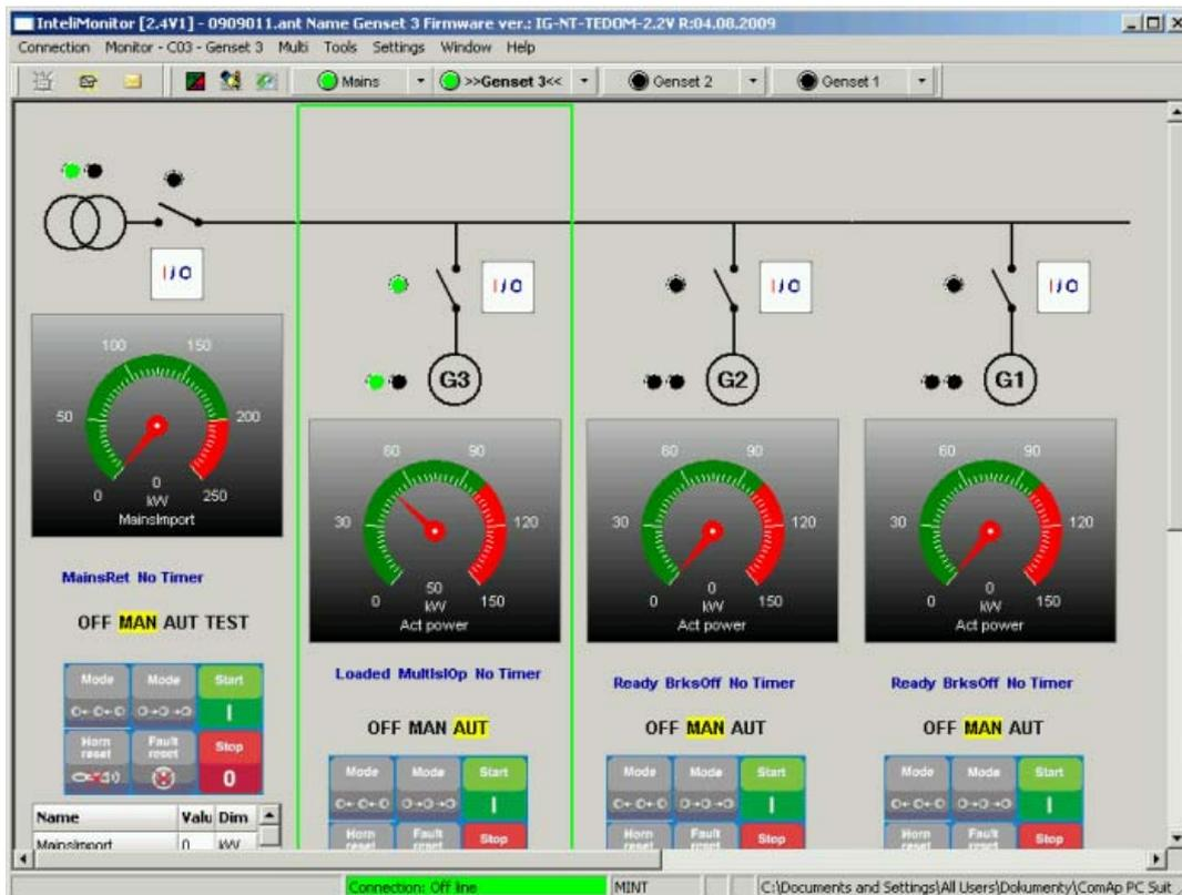
ПАНЕЛЬ С ВЫБРАННЫМ КОНТРОЛЛЕРОМ: КОНТРОЛЛЕР ИМЕЕТ ЗЕЛЕНУЮ РАМКУ
